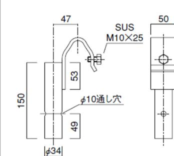
※鉄骨タラップのジョイントには M8×45、取り付け金具の抜け止めに松葉ピンを使用
