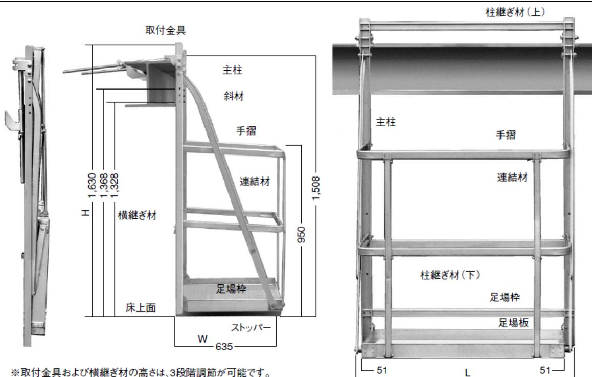
※取付金具および横継ぎ材の高さは、3段階調節が可能です。
